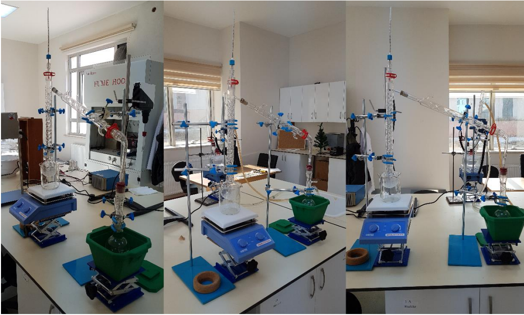
Şekil 2. Solvent geri kazanımı ve saflaştırma amaçlı kullanılan destilasyon sistemi.
